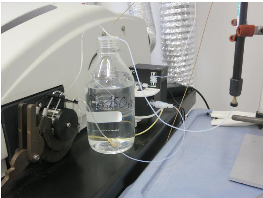
Obr. 4.2: Detail propojení výstupu z kolony, zásobní lahve s vnitřním standardem a zmlžovače spektrometru
