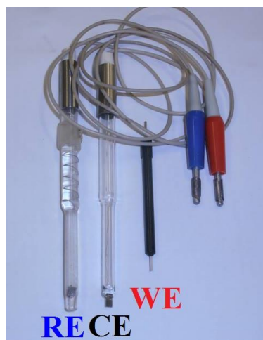
Obr. 3.3: Pracovní elektroda WE : rtuťová filmová elektroda (Ltd „NPP Tomanalit“, Rusko); referentní elektroda RE : chlorido-stříbrná elektroda Ag/AgCl (Elektrochemické detektory, Ltd., Czech Republic); pomocná Pt-elektroda CE (Elektrochemické detektory, Ltd., Czech Republic)
