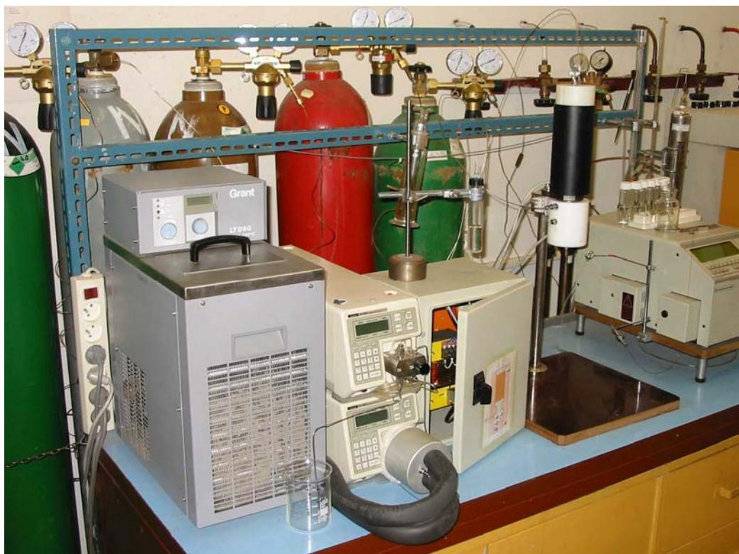
Obr. 2. Přístrojová sestava pro SFE kapalných vzorků
