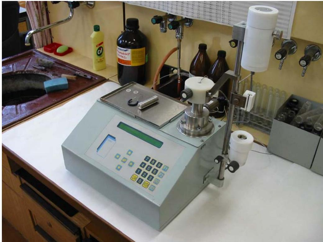
Obr. 13.1: Extraktor pro SFE tuhých vzorků
