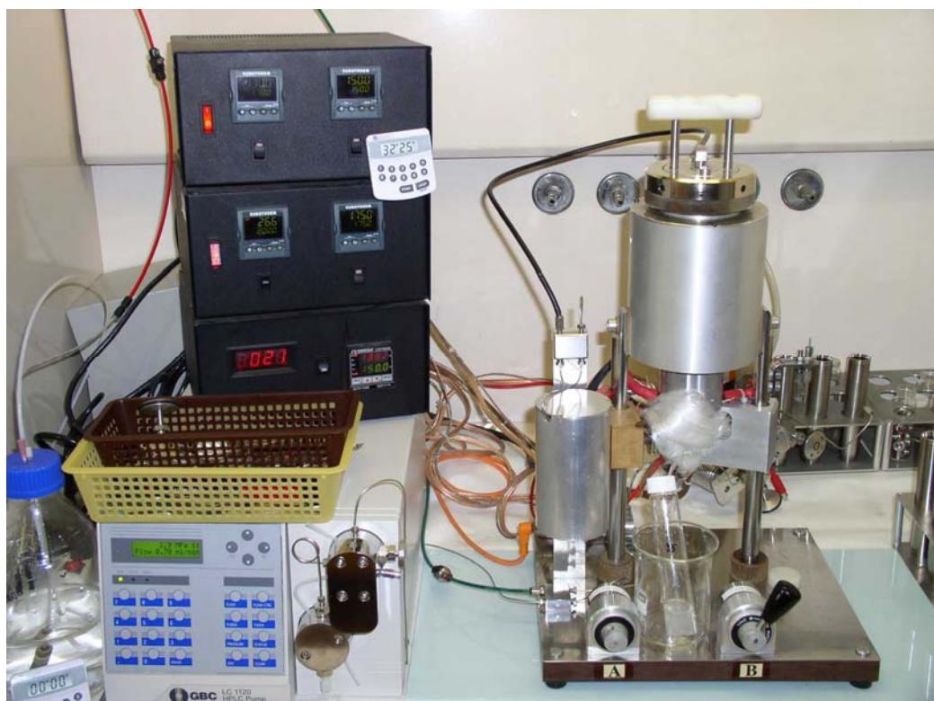
**Obr. 13.4:** Přístrojová sestava pro měření rozpustnosti tuhých látek ve stlačené horké vodě
