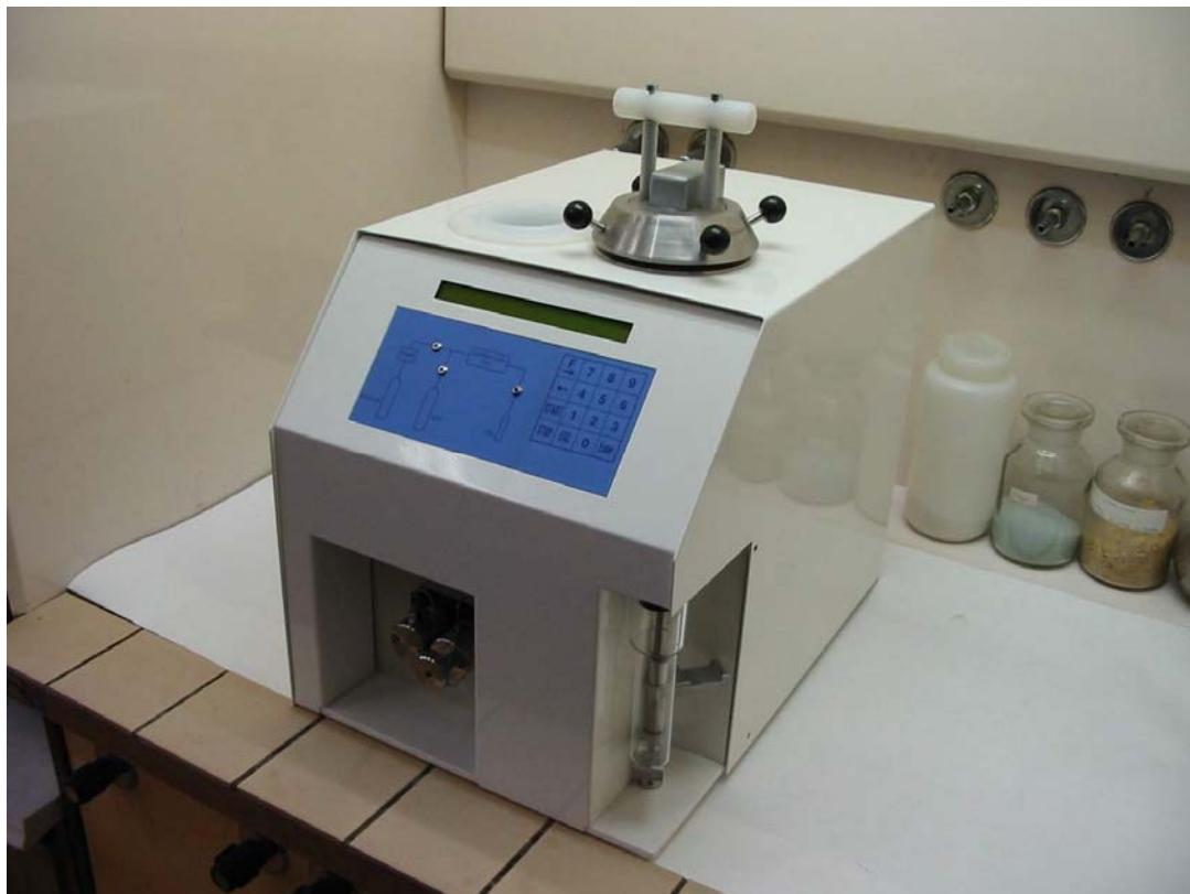
**Obr. 13.3:** Přístroj pro extrakce stlačenými kapalnými organickými rozpouštědly za teplot nad normálním bodem varu rozpouštědla (model s jedinou extrakční celou)
