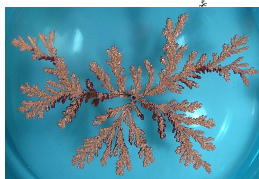
elektrodepozice mědi → credit: wikipedia
