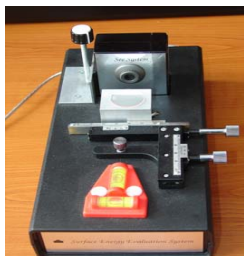
Obr.2: Zařízení pro měření kontaktního úhlu
