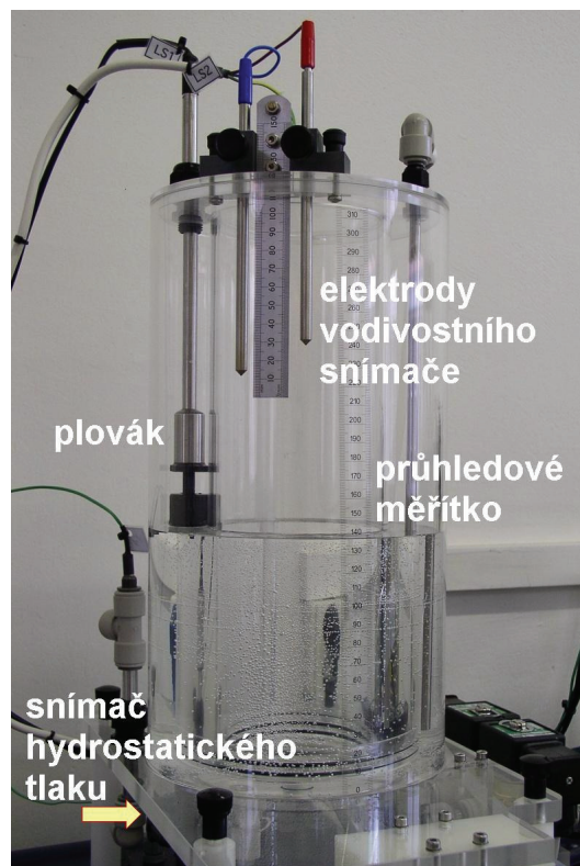
Obr. 5.2 Velká procesní nádoba se snímači hladiny
