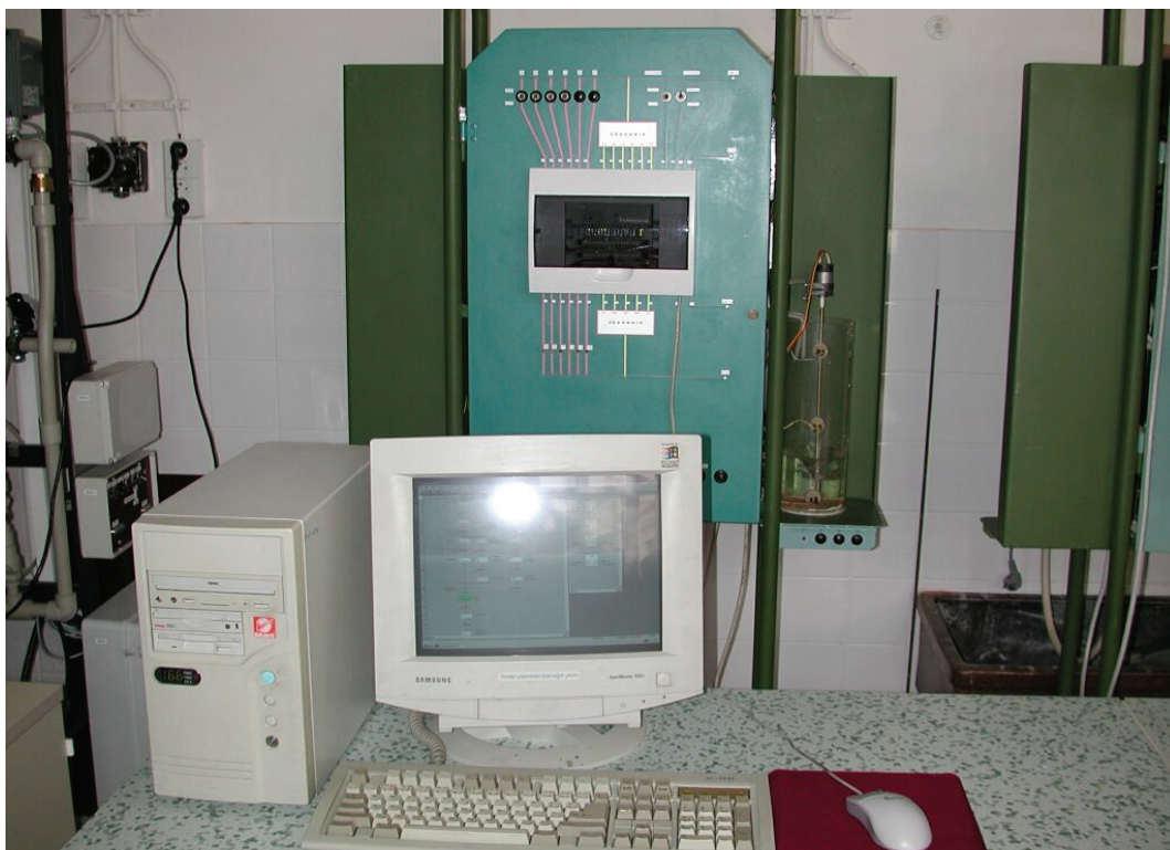
Obr. 8.2 Laboratorní stanice pro úlohy 8.1.b a 8.1.c. Na panelu programovatelný automat, vlevo fyzikální model nádrže a v popředí počítač pro programování a simulaci řídicích programů automatu.
