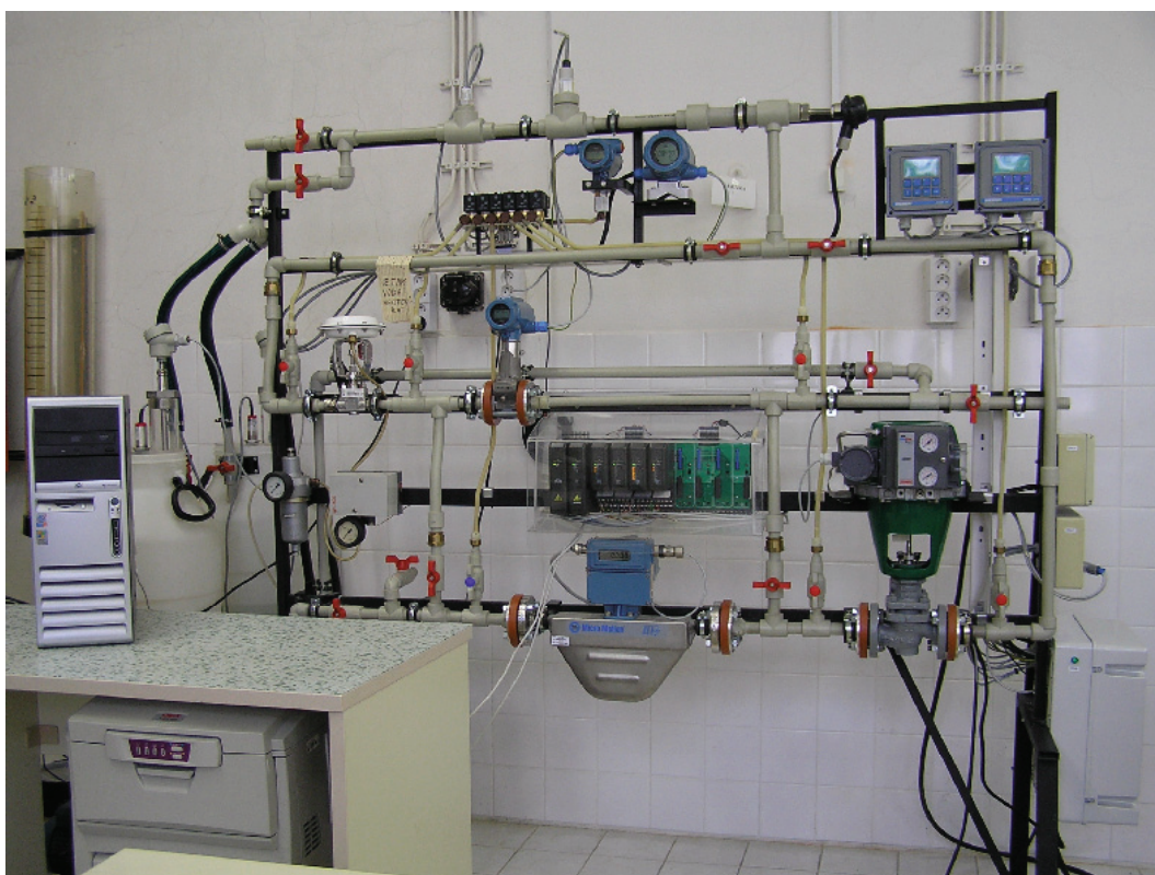
Obr.8.1 Uspořádání průmyslového systému pro snímání dat a regulaci
