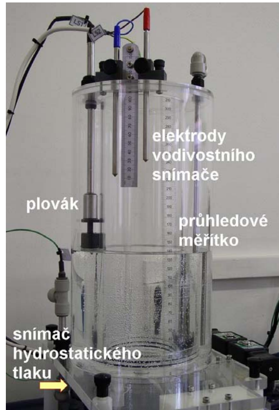
Obr. 2 Velká procesní nádoba se snímači hladiny
