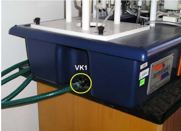
Obr. 6 Výpustní kohout VK1 z odpadního kanálu stanice
