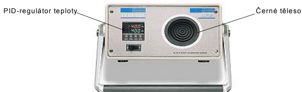
Obr. 13 Kalibrační zařízení s černým tělesem
