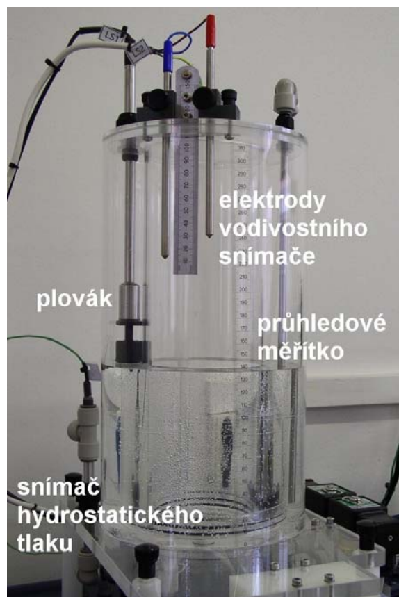
Obr. 2 Velká procesní nádoba se snímači hladiny
