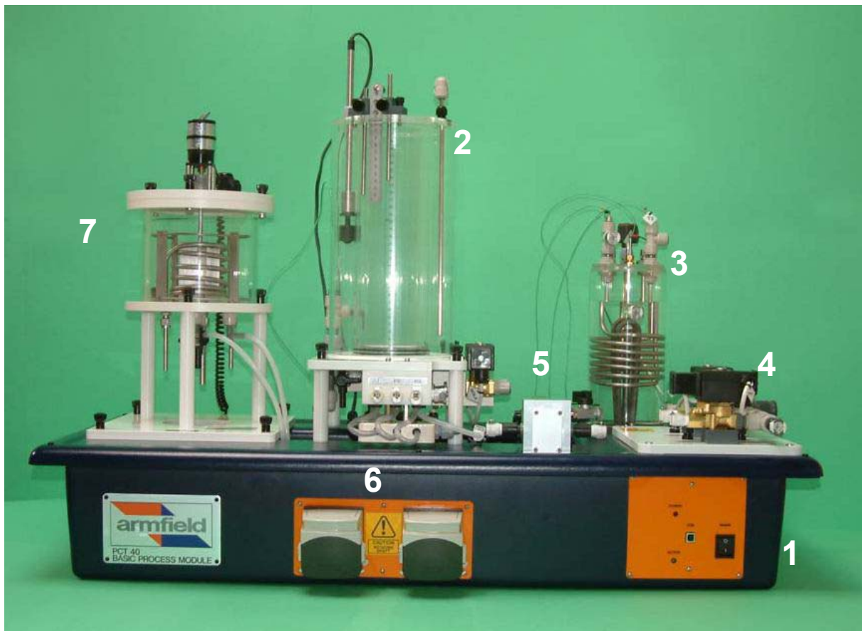
Obr. 1 Multifunkční systém pro výuku provozního měření a řízení
