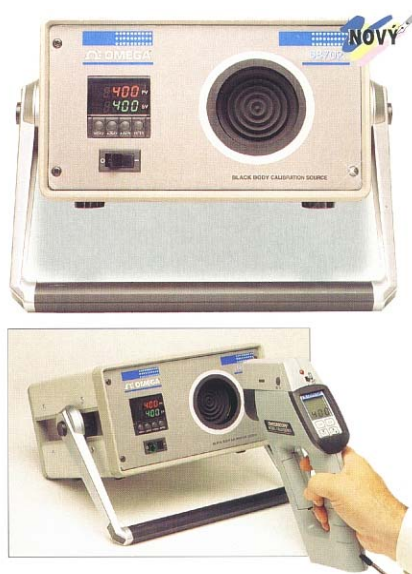
Obr. 8 Kalibrace bezdotykového teploměru
