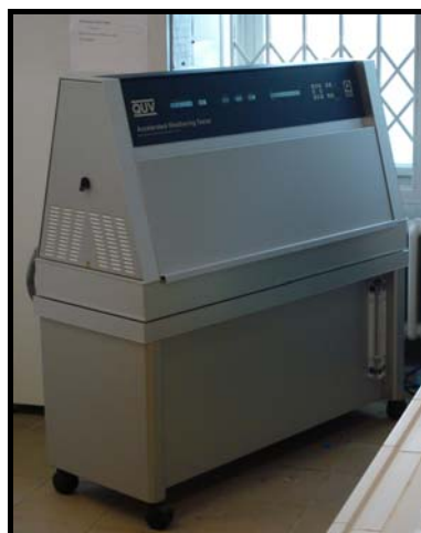
QUV –A-spray panel k simulaci povětrnostních podmínek
