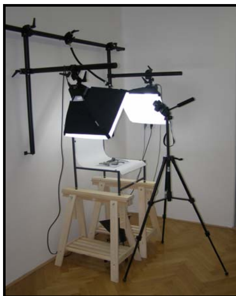
Zařízení pro fotografickou dokumentaci v laboratoři S44a
