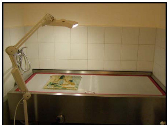
Vana z korozi vzdorné oceli pro mokré procesy s odsáváním (textil, archiválie) v S44c
