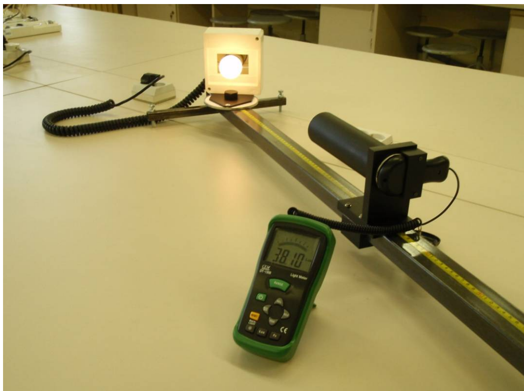
Obr. 5: Optická lavice s otáčivým zdrojem světla a luxmetrem
