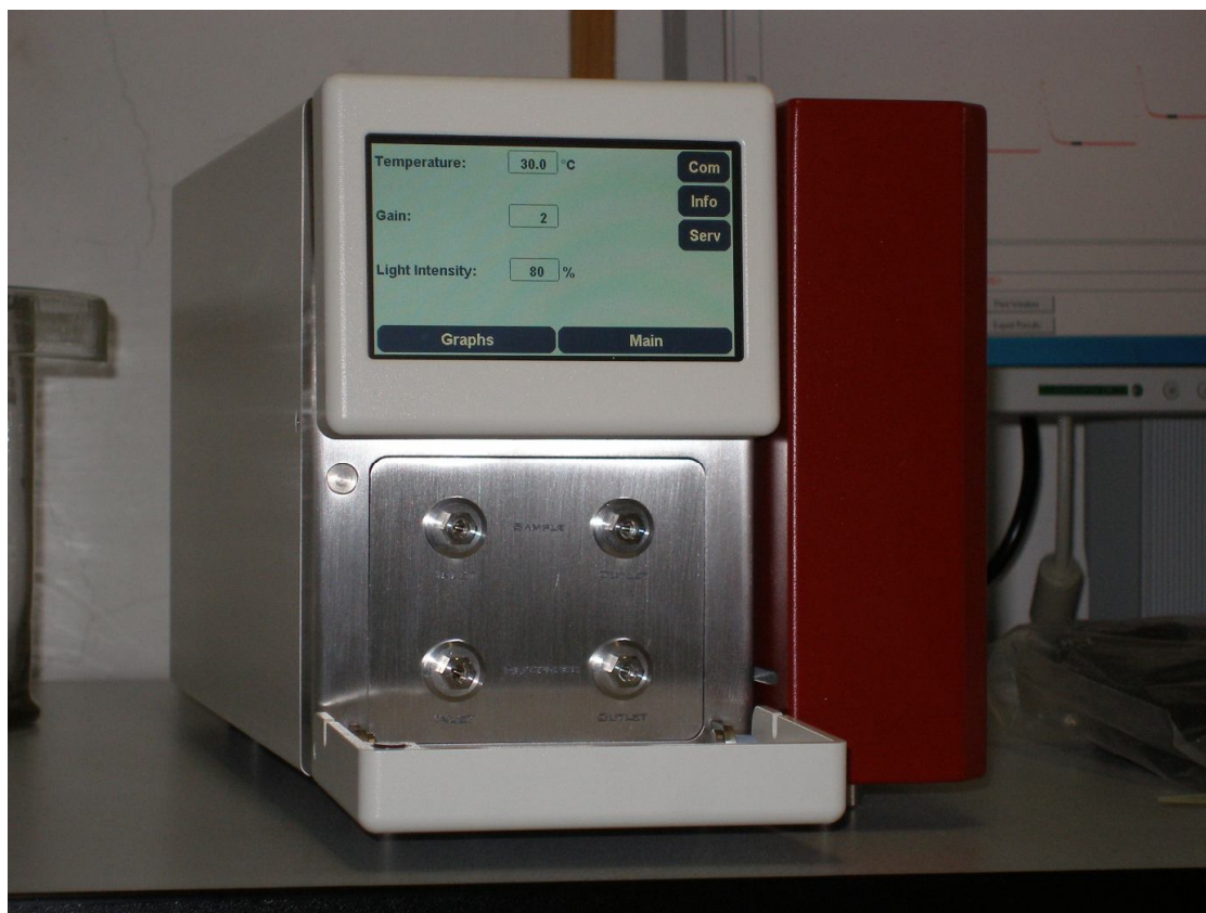
Obrázek 2: Diferenciální refraktometr WGE SEC – 3010
