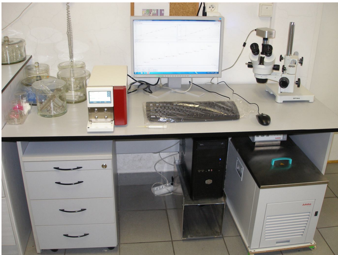
Obrázek 3: Celkový pohled na pracoviště pro stanovení sorpce kapalin v polymerní membráně
