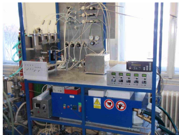
Indukční generátor pro ohřev reaktoru na depozici tenkých vrstev oxidových materiálů (modrý přístroj). Zakoupený indukční generátor umožňuje docílit velmi rychlé změny teploty a jeho vyšší výkon umožnil zásadní modifikaci geometrie susceptoru pro depozici tenkých vrstev. Cena dodaného zařízení je 691 518 Kč, 630 000 Kč bylo zapláceno v rámci řešení RP. Přístroj je instalován a využíván pro výuku na Ústavu anorganické chemie.
