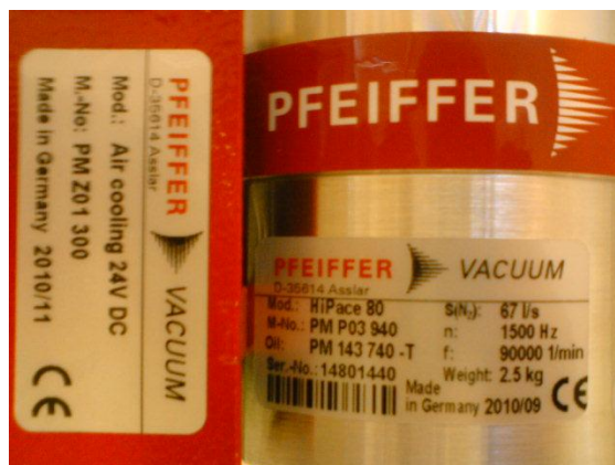
Obr.7. Turbomolekulární vývěva(TMP) je součástí naprašovacího zařízení.
