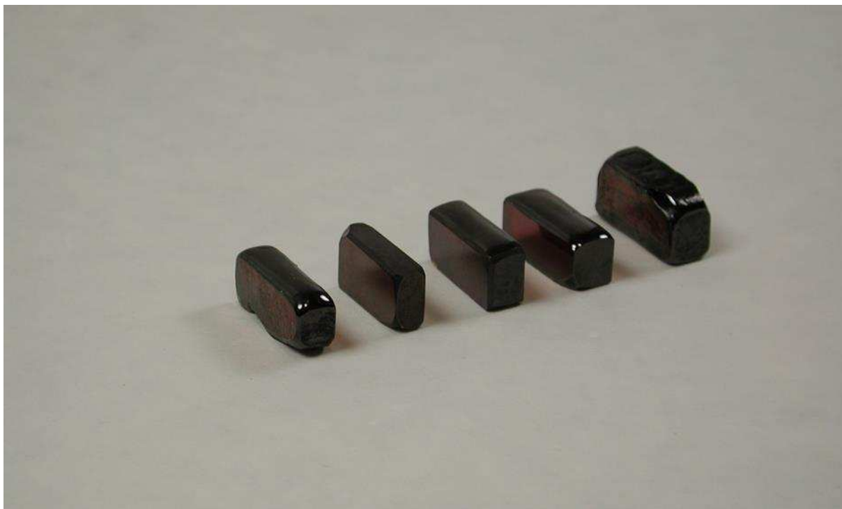
Obr. 3 Odlité vzorky magneto-optického skla připravené pro následné tepelné zpracování.
