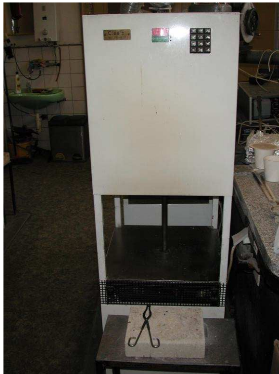
Obr. 1 Elektrická superkanthalová tavičí pec Clasic.
