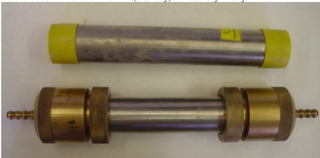
Obr. 7: Odběrové válce se vzorkem (utěsněný) a s nasazenými čely
