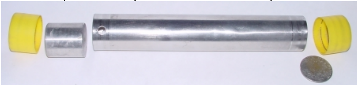
Obr. 9: Detailní pohled na odběrový válec včetně těsnících uzávěrů a vymezovacích vložek
