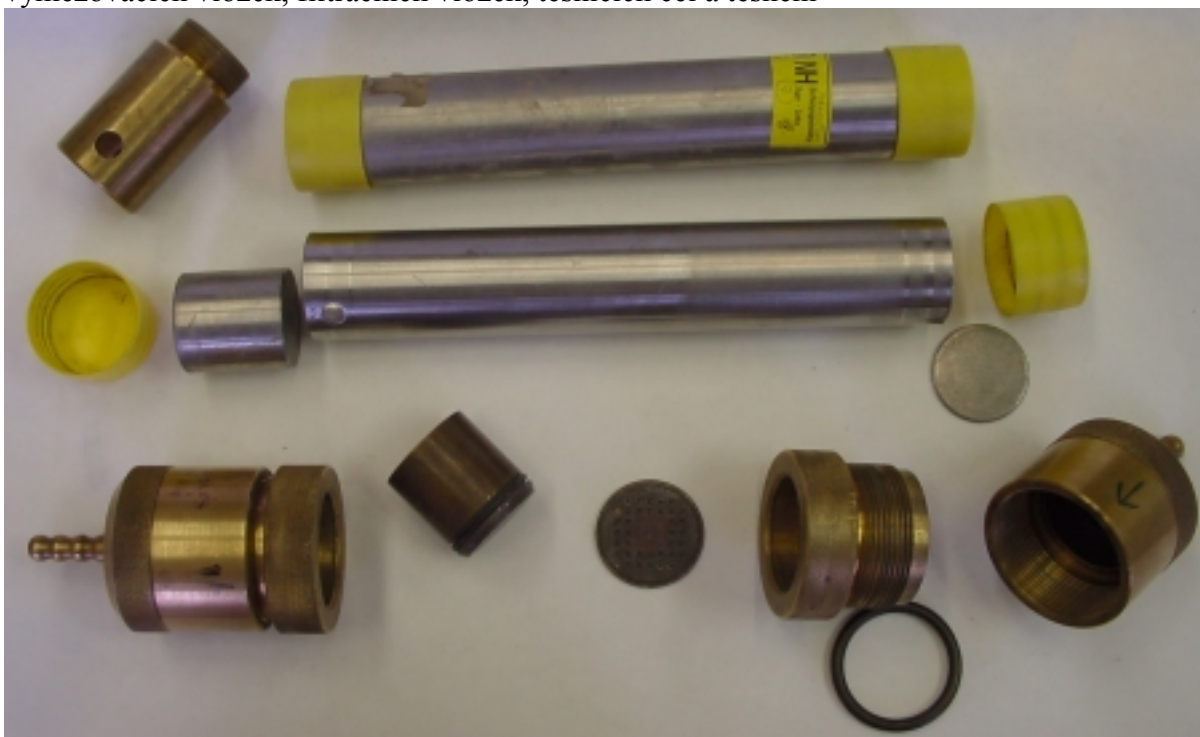
Obr. 10: Detailní pohled na rozebraný kompletní odběrový válec včetně těsnících uzávěrů, vymezovacích vložek, filtračních vložek, těsnících čel a těsnění
