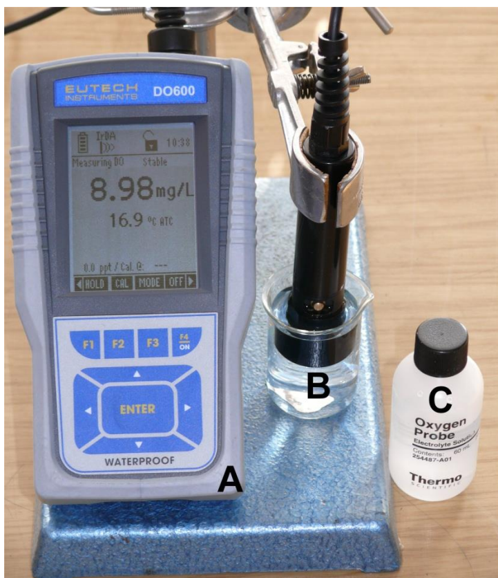
Obrázek 7: Systém pro měření kyslíku složený z měřicího zařízení (A), kyslíkového čidla (B) a plnicího roztoku (C).
