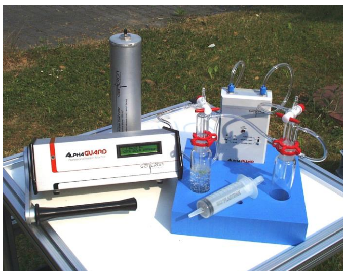
Obrázek 6: Sestava pro měření radonu ve vzorcích vody s připojením adaptérů: pumpy pro nasávání vzorku a absorbéru.
