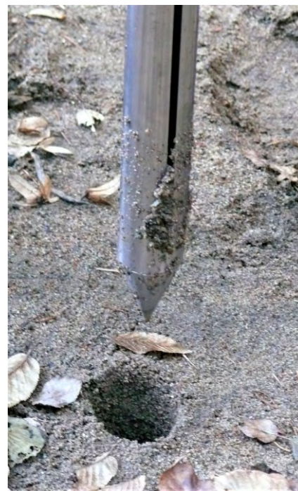
Obr. 21 Vytažení trubice se vzorkem
