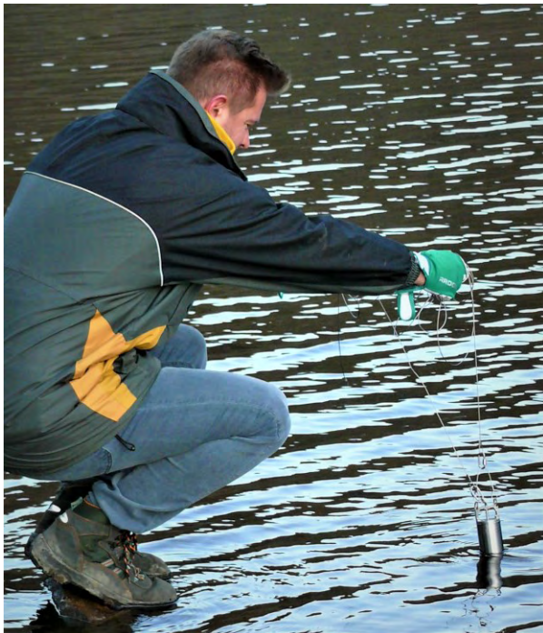
Obr. 7 Ponoření sondy pod hladinu a její naplnění
