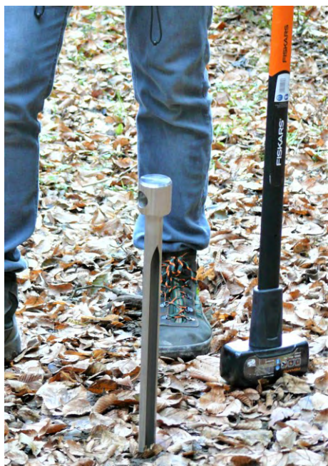
Obr. 17 Zarážení trubky do půdy pomocí kladiva
