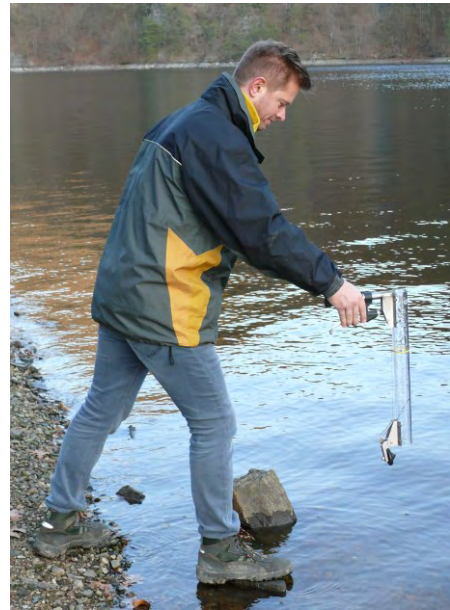
Obr. 3 Práce s Andělovou tyčí
