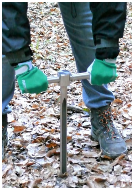
Obr. 18 Vytažení trubky pomocí rukojetí
