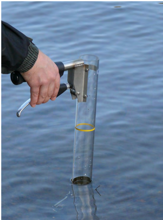
Obr. 4 Ponoření vzorkovače pod hladinu
