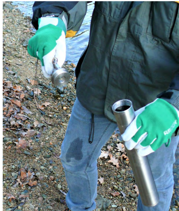
Obr. 8 Zajištění odebraného vzorku
