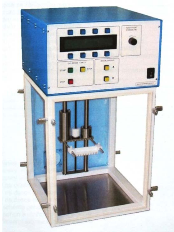
Obr. 2: Box na potahování substrátů (dip-coater)
