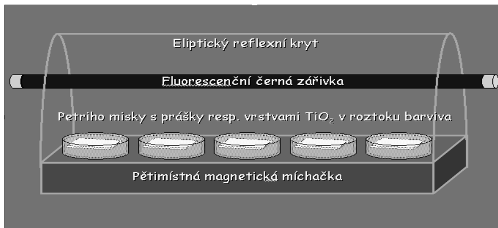
Obr.3 Pětimístná magnetická míchačka
