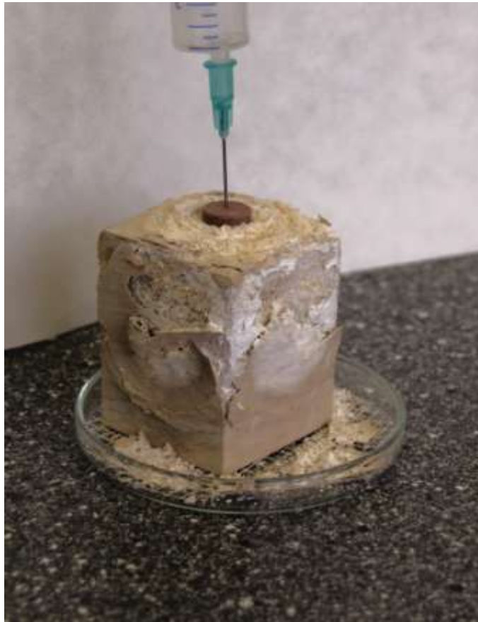
Obr. 1: Degradace opukového zkušebního tělíska bez povrchové úpravy vyvolaná působením síranu sodného
